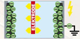
04 Der Feinstaub sammelt sich an der Kaminwand an und wird gebunden. Diese Ablagerungen werden bei der Reinigung durch den Kaminfeger entfernt.
