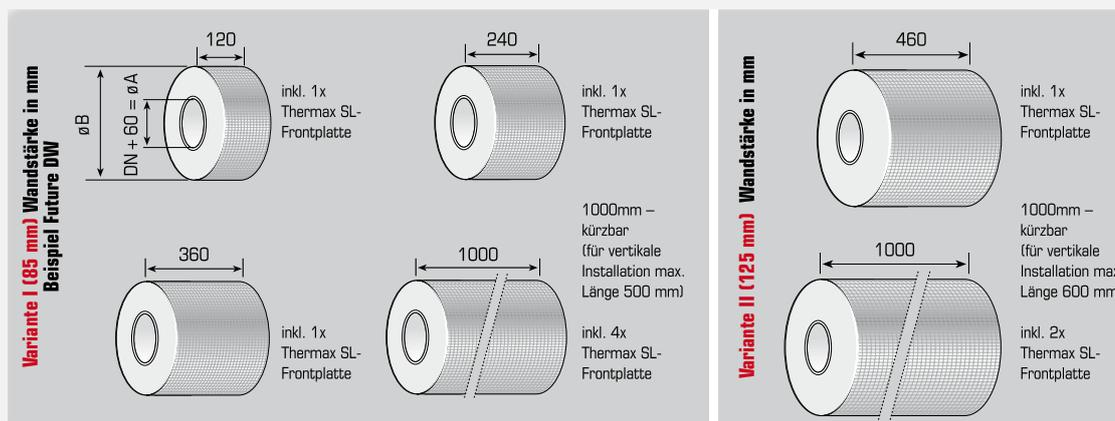
**Schräder Wand-, Decken- und Dachdurchführung als luftdichte Ausführung**
